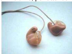
Figura 5. Monitor intrauricolari personalizzati (Fonte: Linee guida europee [1]).
